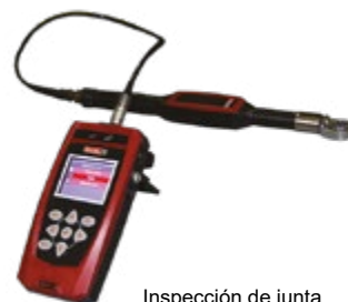
Inspección de junta post-producción (DWTA)
