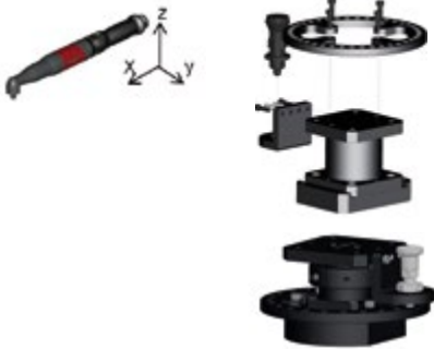
Brida con giro indexado sobre eje Z
