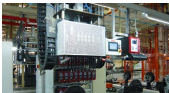
Un cuadro eléctrico con parada de em., tomas Ethernet, Multicombox y disyuntores
